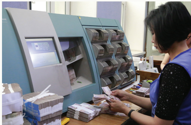
2017 он: Мөнгө тоологч. Уг машин нь мөнгөн дэвсгэртүүдийг сайн, муу, хүчингүйгээр нь ялган тоолж, хуурамч дэвсгэртийг таньж илрүүлдэг.
